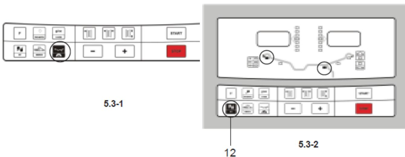
Станок всегда автоматически устанавливает одну из программ балансировки (т. е. программу установки грузов). Указанной клавишей (см. рис. 5.3-1) можно выбирать программы балансировки. Выбранная программа индицируется соответствующим светящимся указателем.
