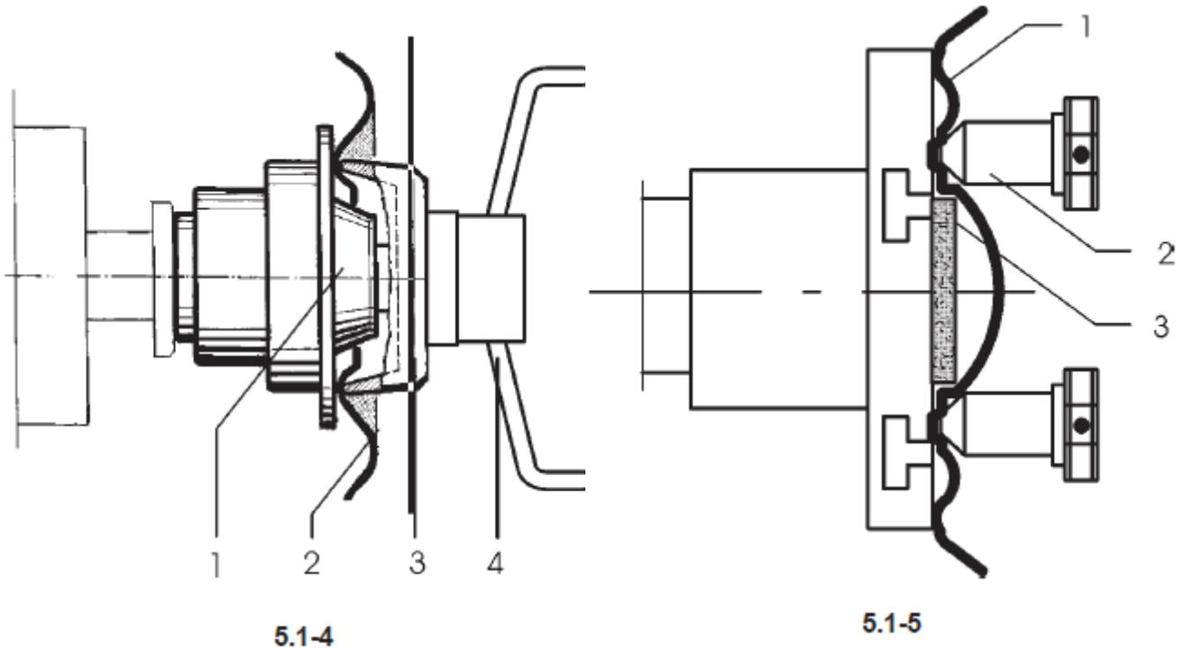
На рис. 5.1-4 показано крепление на станке обычного колеса легкового автомобиля с помощью центрально центрирующего зажимного устройства.
