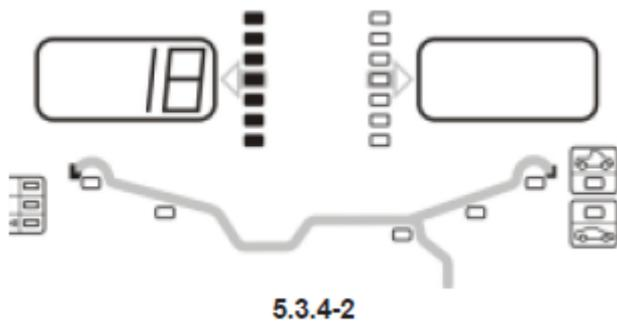
Указание. В правильном положении колеса светятся все элементы указателя. Если колесо повернули дальше нужного положения, светятся только те элементы, которые расположены в этой половине указателя. См. рис. 5.3.4-3. В этом случае колесо следует несколько повернуть в обратном направлении.
