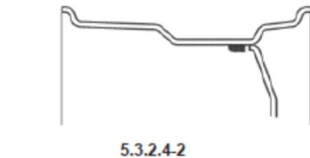
Выбирайте эту программу для достижения высокой точности балансировки, для установки грузов за спицами или для балансировки специальных колес (PAX, TRX, CTS и т. д.)
