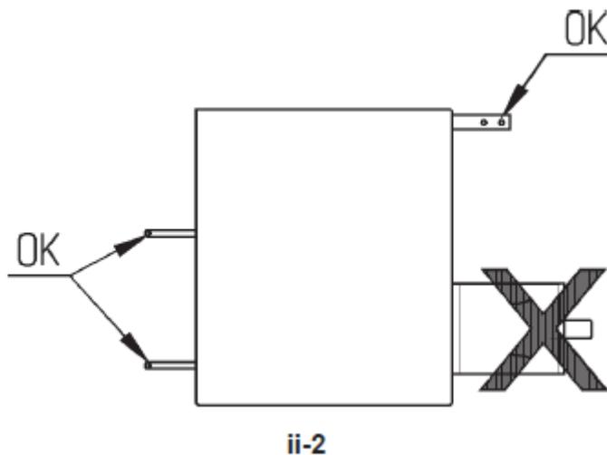
**Указание.** Для перемещения станка используйте преимущественно держатели для принадлежностей (они монтируются так, как описано в разделе iii) и (или) вал защитного кожуха колеса (при его наличии).
