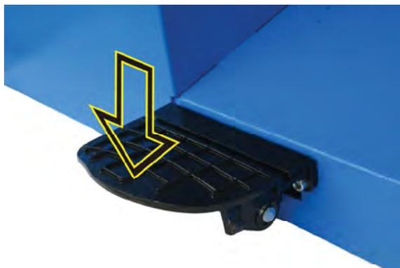
Главный вал блокируется нажатием педали. Эта функция облегчает затяжку и ослабление зажимной гайки и удерживает колесо в положении коррекции для правильной установки балансировочных грузов.
